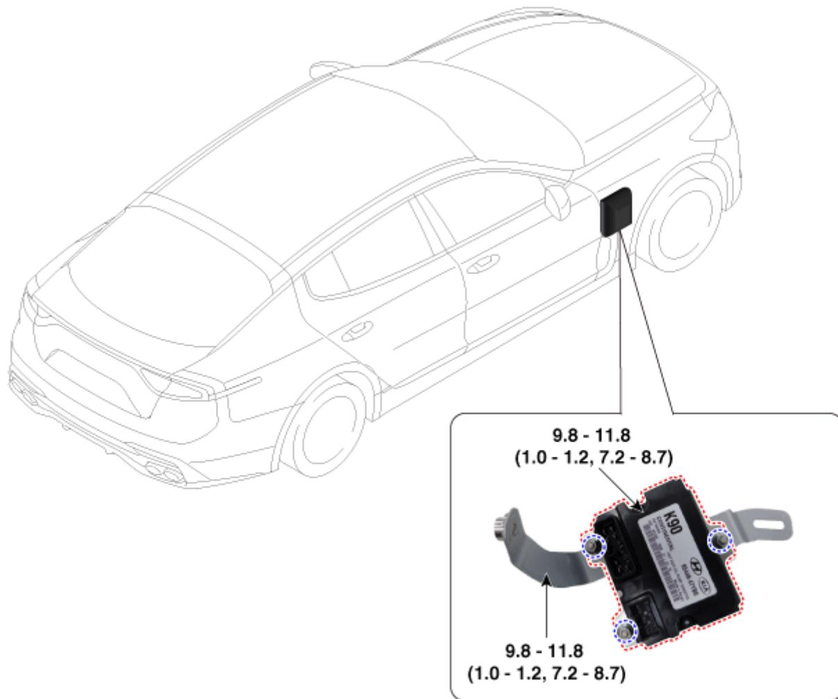
Tightening torque : N·m (kgf·m, lb·ft)
